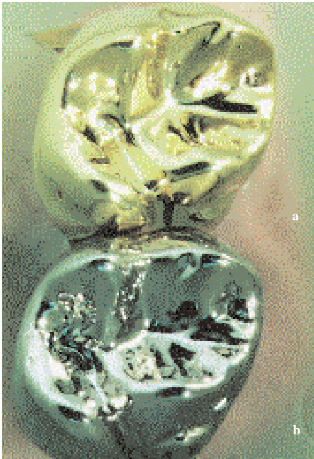
Abb. 7a und b Titanpolitur im Vergleich mit Goldpolitur a) Okklusionsfläche einer Goldkrone b) Titankrone
