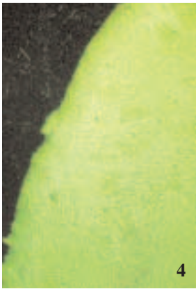
Abb. 4 Metallographisches Schliffbild eines modernen Titangusses. Geätzt. Durch Gussoptimierung und modernste Einbettmassen ist die \alpha -case-Schicht kaum mehr vorhanden. Vergrößerung: 50 \times
