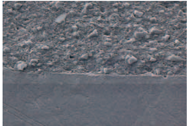
Fig. 2 Kompomer (F2000): Charakteristisch geringe Randspaltbreite, gemischte Klasse-II-Füllung, nach Belastung.
