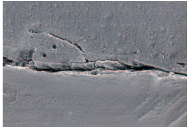
Fig. 3 Komposit (Definite): Charakteristische Randspaltbreite und Schmelzrandfrakturen, gemischte Klasse-II-Füllung, nach Belastung.
