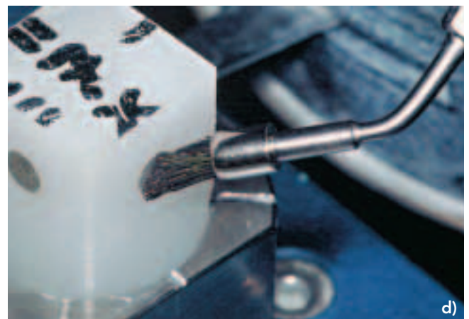
Abb. 2 Beispiele der Materialbearbeitung: a) Sonobürstchen auf Schmelzprobe; b) Gummikelch auf Kompositprobe; c) Rotierendes Bürstchen auf Goldprobe; d) Sonobürstchen auf Amalgamprobe
