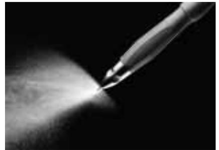
Der einstellbare Wasserspray eignet sich besonders für die Bearbeitung keramischer Materialien. Der Betrieb mit Wasserspray erhöht die Standzeiten der Werkzeuge, verkürzt die Ausarbeitungszeit und verbessert die Oberflächenqualität der Arbeiten.
