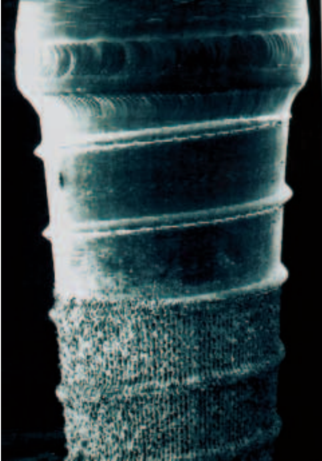
Abb. 3 Elektronenmikroskopische Aufnahme des Implantathalsbereichs mit dem Titanring und den beiden Schweissstellen (Vergrößerung 80-fach).
