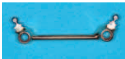
Abb. 1 Ein U-förmiger Steg mit ange-löteten Mini-SG-F®-Geschieben.
