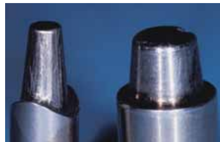
Abb. 2 Teststümpfe aus Edelstahl (Prämolaren- und Molarenform)
