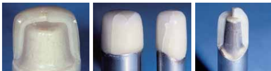
Abb. 8 Frakturbilder der Procera-kronen
