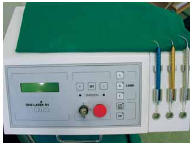
Abb. 1 Zentrale Einheit des ORA-LASER 01 I.S.T mit Bedienungsdisplay und den drei Fasern der Stärken 200 \mu m, 400 \mu m und 600 \mu m.
