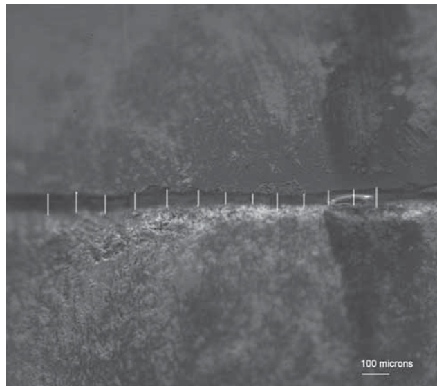
Abb. 5 Exemplarischer marginaler Randspalt am Epoxidharzreplikant unter Stereolichtmikroskopie (Stemi 2000 CS; Carl Zeiss, Jena, D) (200×). Orthoradiale Randspaltmessung in Abständen von ~ 100 µm.
