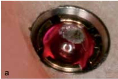
**Abb. 9** a) Frakturierter Titanpin mit intakter Rubinkugel, b) Titanbasis nach Fraktur des Pins.
