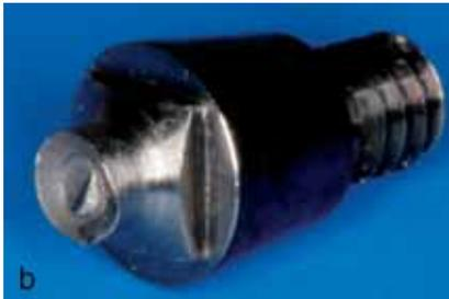
**Fig. 9** a) Axe en titane rompu avec sphère en rubis intacte, b) base en titane après rupture de l'axe.
