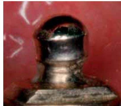
**Fig. 1** Ancre sphérique en alliage or avec de nets signes d'usure.
