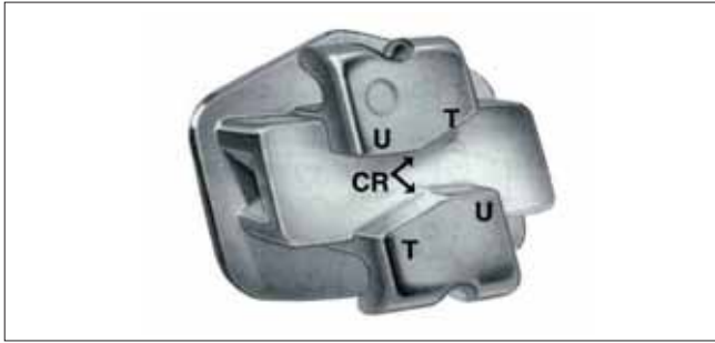
Abb. 3 Das neue Tip-Edge Plus Bracket (.022 Inch Slot) für den Zahn 13: «tipping»-Flächen (T) limitieren den Kronen-Tip. Aufrichtflächen (U) für die Kontrolle des finalen Tip und Tork. Zentrale Ränder (CR) gewährleisten die vertikale Kontrolle während des initialen Tippens und des finalen Torkens. Ganz links der trichterförmige Eingang des «deep tunnel» für den Ni-Ti-Draht in Phase III.
