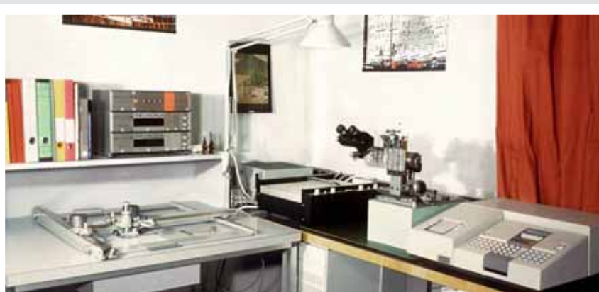
Computeranlage aus dem Jahre 1973 mit Messmikroskop zur Vermessung von Modellen und Koordinatograf (Streit & Haag, Bern) zur Vermessung und Analyse von Fernröntgenbildern.
