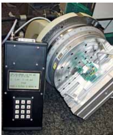
Im Bundesamt für Metrologie METAS in Bern wird der Inklinometer zur Messung der Kopfneigung samt Minicomputer zur Speicherung der Daten auf Herz und Nieren auf seine Genauigkeit überprüft und bekommt ein Zertifikat.
