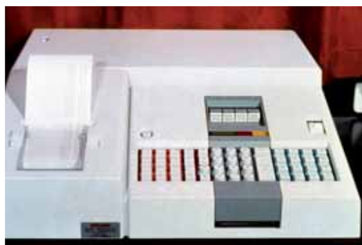
Minicomputer der Firma Olivetti P632, programmierbar über Magnetkarten in Maschinensprache und Anschlussmöglichkeit für periphere Geräte.
