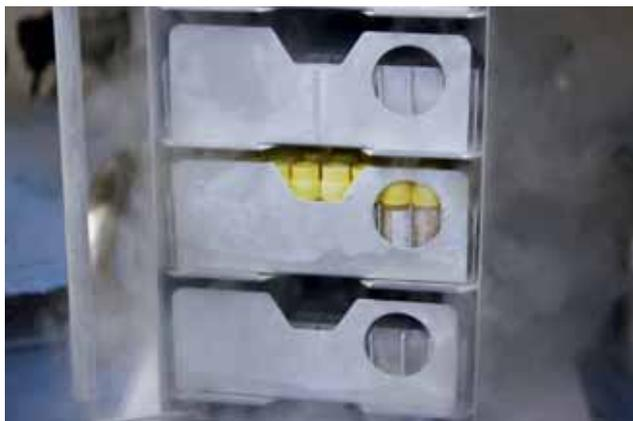
**Fig. 8** Disposés dans des cassettes ad hoc, les conteneurs sont placés dans un réservoir rempli d'azote liquide.
