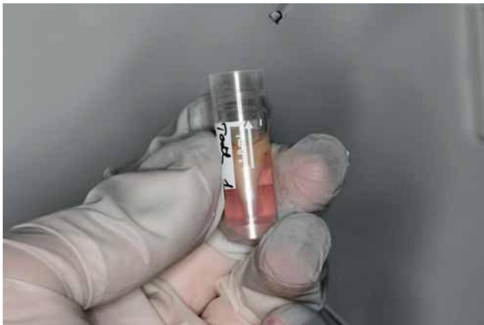
**Image** en haut: Récipient approprié pour la cryopréservation; le flacon est rempli d'un mélange d'agents nutritifs et d'un cryoprotecteur (antigel).
