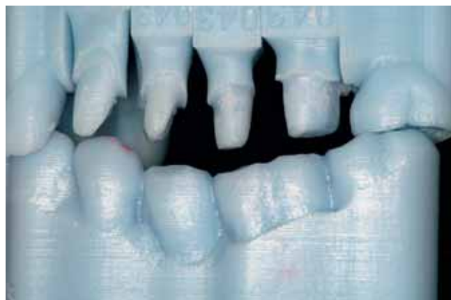
Fig. 13a, b Modèles fabriqués par stéréolithographie: a) modèle arcade complète, b) détail du modèle
