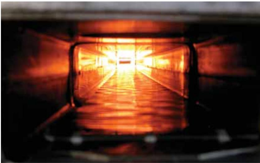
Der Ofen, in dem die Geräte gehärtet werden.
