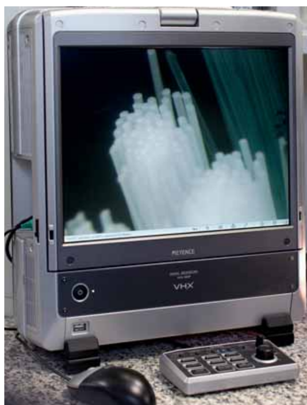
Im digitalen Mikroskop wird unter 500-facher Vergrösserung die Abrundung der Bürstenfilamente kontrolliert.
