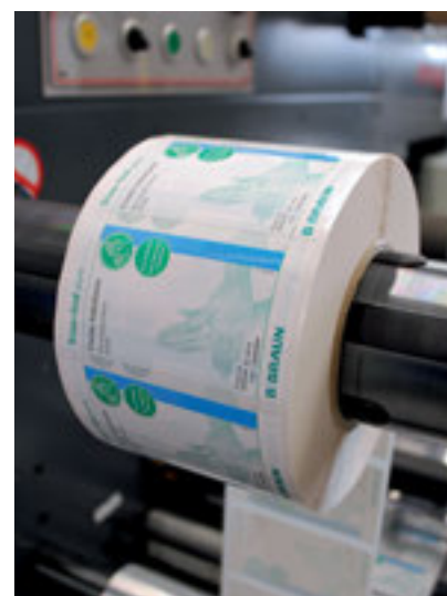
Auf dem betriebseigenen Drucksystem werden die Etiketten für die Vielzahl der B.-Braun-Produkte gedruckt.
