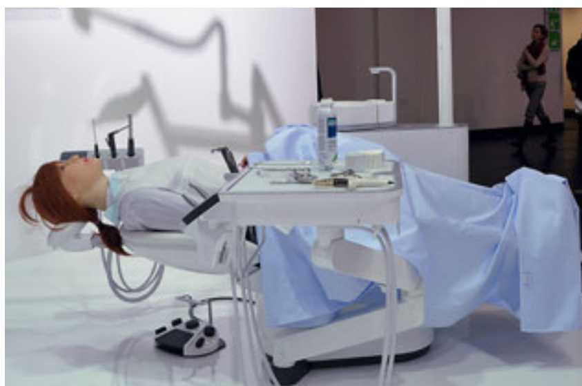
Die Simulationspatientin SIMROID der Firma Morita liegt schon im Stuhl bereit. Zukünftig sollen angehende Zahnmediziner an ihr möglichst realitätsnahe Behandlungen und einfache Kommunikationstrainings üben können. Beim Bohren in die künstliche Zahnpulpa «empfindet» sie sogar Schmerzen.
