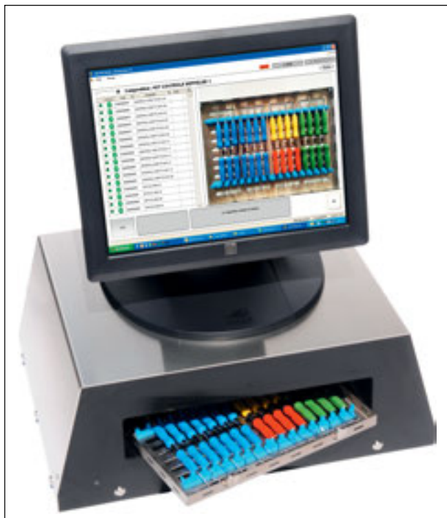
Abb. 5 Denta-Line-Tunnel zum automatischen Lesen der RFID-Tags.
